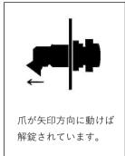
・ダイヤル錠を本体 扉の楕円の孔に差し込み、ワッシャー、ナットの 「「」」 順に入れ、ツメが本体に引っかかる位置で、ナットの向きを確認してしっかり締めて 下さい。(下図参照)
